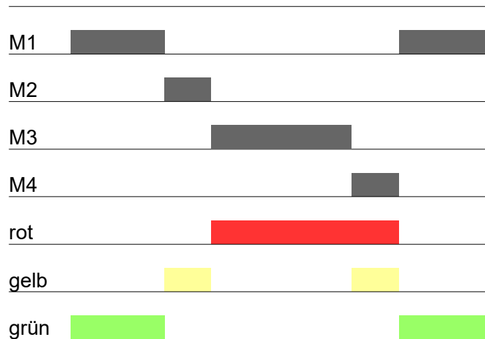
Abb. 7.4: Zeitablaufdiagramm einer einfachen Ampelsteuerung
