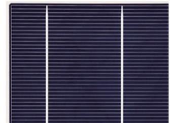
Abbildung 8: Kontaktfinger auf einer Solarzelle
