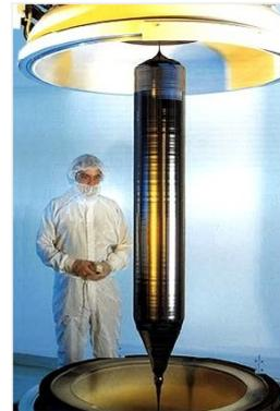
Abbildung 14: Monokristalliner Siliziumstab
