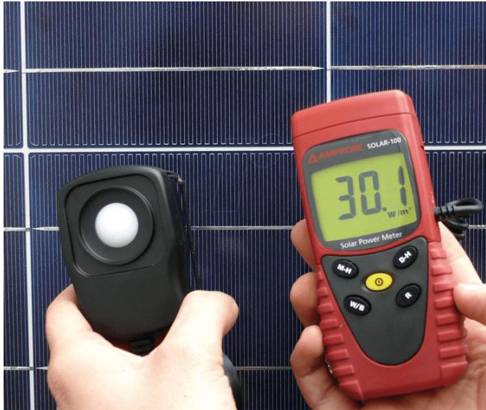
Das Einstrahlungsmessgerät (Solar Power Meter) zeigt die Einstrahlung  $E$  in  $W / m^2$  an.
