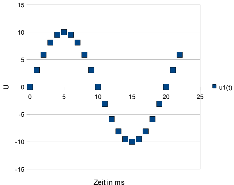
Konstruktion eines sinusförmigen Signals aus Einzelwerten
